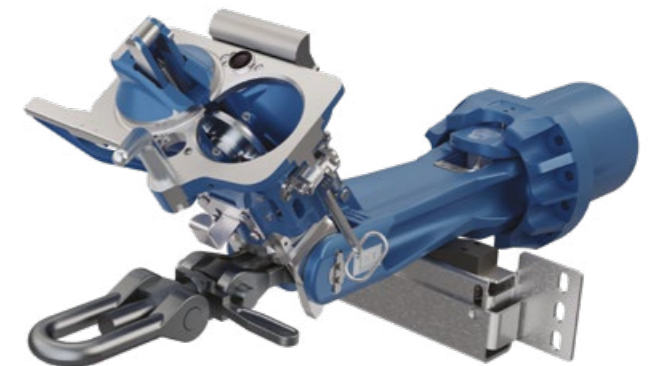
HYBRID DAK FÜR LOKOMOTIVEN MIT SCHRAUBENKUPPLUNGSMODUS
